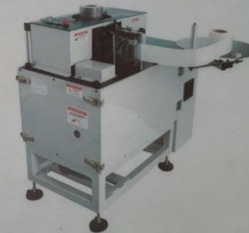
MAQUINA INSERTADORA DE PAPEL AISLANTE PARA ESTADORES
